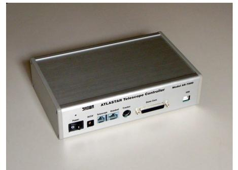
別売りの USB 対応望遠鏡制御コントローラ「ATLASTAR」を接続すると、付属の ATLAS Basic Edition 望遠鏡コントロールソフトによりさまざまな駆動速度が設定でき、彗星、小惑星等の観測も可能です。また、コンピュータの画面上で天体の自動導入ができ、市販の天体シミュレーションソフトと組み合わせると、マウスによる天体の自動導入が可能です。自動導入の動作を繰り返すことによる累積誤差は生じません。新機能として、バックラッシュ補正が可能となりました。別売りの自動観測プログラムは、ATLAS Basic Edition にアドインが可能です。指定時刻に目的の観測対象に望遠鏡を自動で向けることが可能です。
