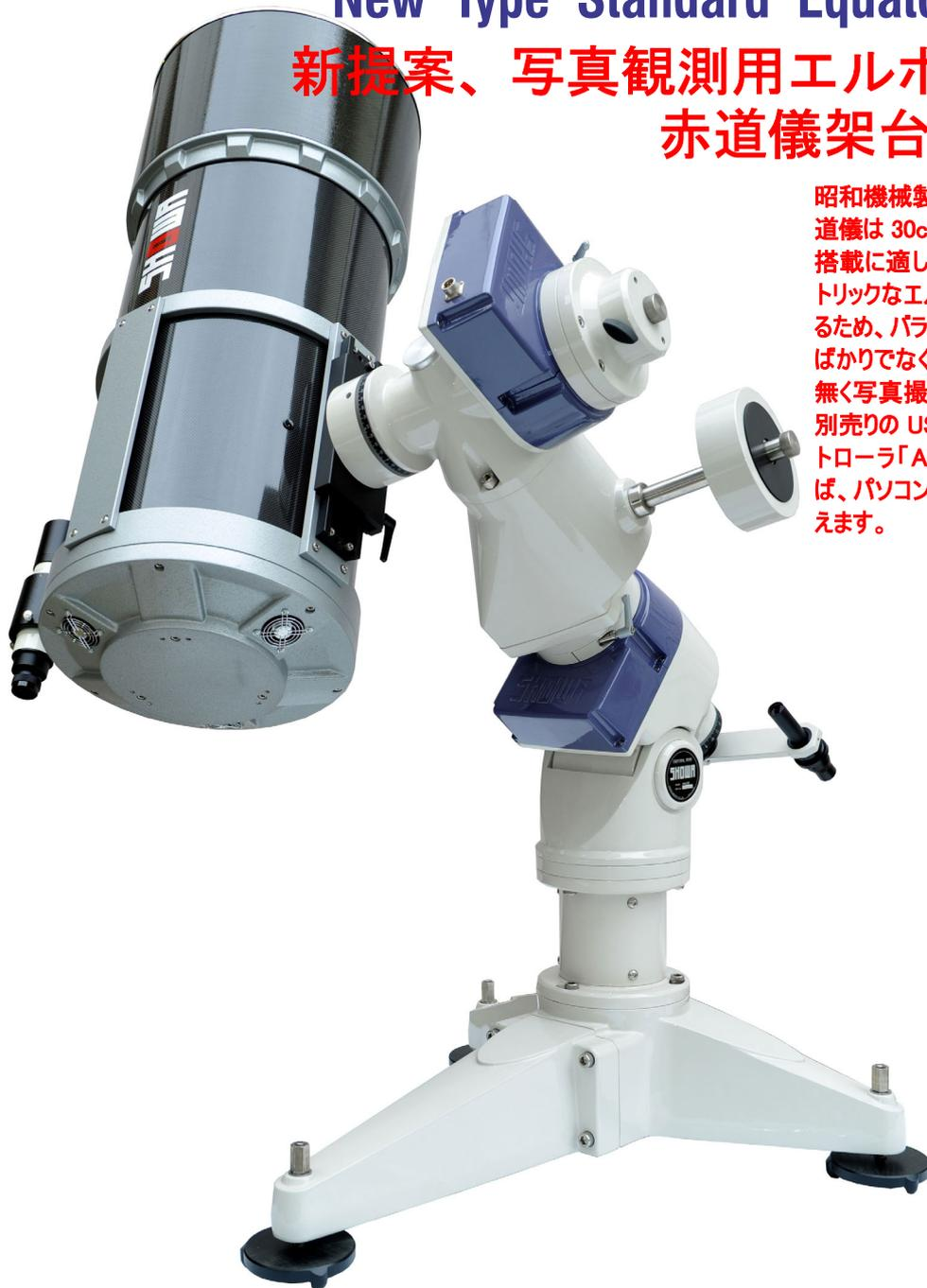
昭和機械製作所の NEW20EL 型赤道儀は 30cm クラスの反射望遠鏡の搭載に適した赤道儀です。エキセントリックなエルボー方式を採用しているため、バランスウエイトが極小ですむばかりでなく、子午線通過の制限が無く写真撮影にも適した形式です。別売りの USB 対応望遠鏡制御コントローラ「ATLASTAR」を装着すれば、パソコンで天体の自動導入も行えます。
