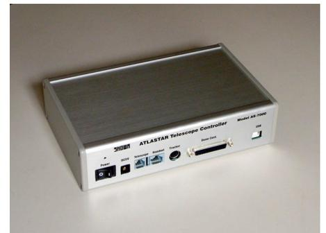
別売りの USB 対応望遠鏡制御コントローラ「ATLASTAR」を接続すると、付属の ATLAS Basic Edition 望遠鏡コントロールソフトによりさまざまな駆動速度が設定でき、彗星、小惑星等の観測も可能です。また、コンピュータの画面上で天体の自動導入ができ、市販の天体シミュレーションソフトと組合せると、マウスによる天体の自動導入が可能です。自動導入の動作を繰り返すことによる累積誤差は生じません。新機能として、バックラッシュ補正が可能となりました。別売りの自動観測プログラムは、ATLAS Basic Edition にアドインが可能で、指定時刻に目的の観測対象に望遠鏡を自動で向けることが可能です。
